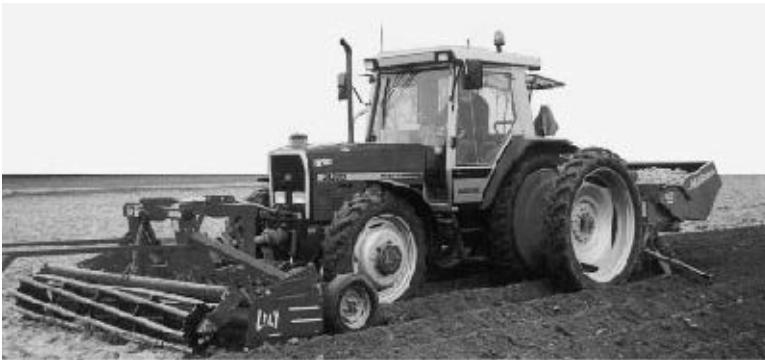
Figuur 2-1: Een aardappelpootmachine in combinatie met een grondbewerkingswerktuig en rugvormers
